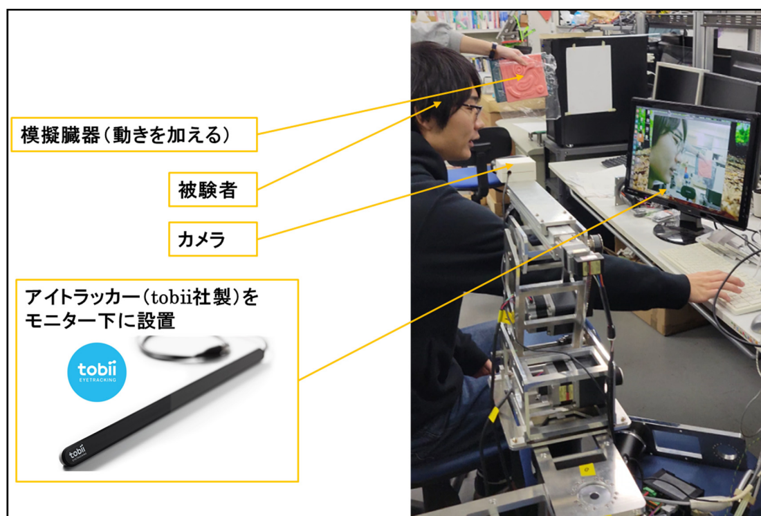
図4 視線入力システムによるロボット動作実験環境
